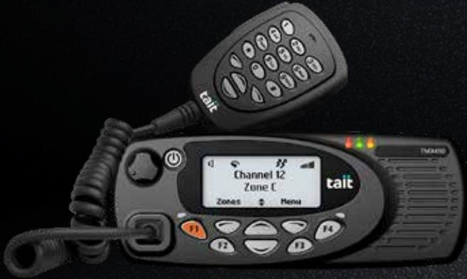
A cabeça de controle remota, permite a visualização de informações no painel do aparelho, além de permitir a instalação do corpo do rádio em qualquer lugar do veículo.
