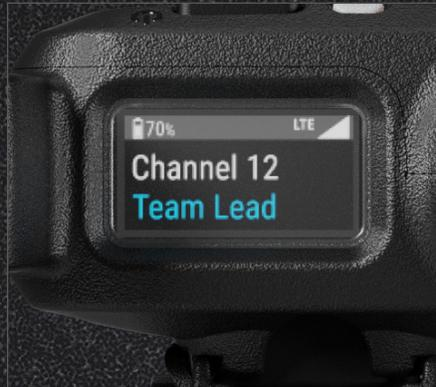
O visor superior fornece informações rápidas sem a necessidade de colocar o dispositivo à vista.
