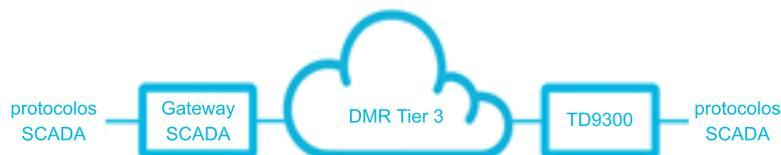
O TD9300, em conjunto com uma rede SCADA Gateway e DMR tier III, oferece serviços avançados de comunicação de dados para redes sem fio.
